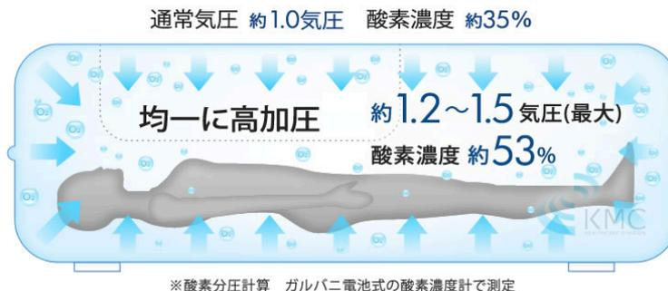
標準の酸素濃縮器を接続した場合、空気21%+高濃度酸素5L・93%の「酸素加圧」となります。
